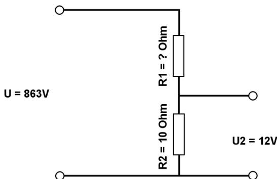
Berechne mit der Spannungsteilerregel die fehlenden Werte.
