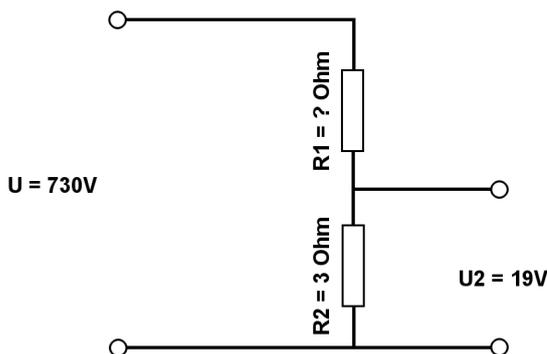
Berechne mit der Spannungsteilerregel die fehlenden Werte.
