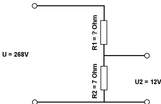
Berechne mit der Spannungsteilerregel die fehlenden Werte.
