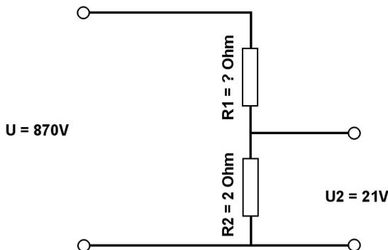
Berechne mit der Spannungsteilerregel die fehlenden Werte.
