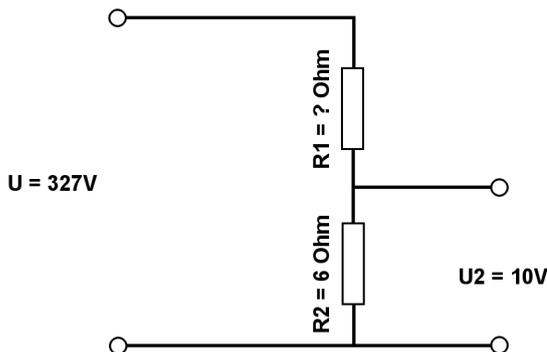
Berechne mit der Spannungsteilerregel die fehlenden Werte.
