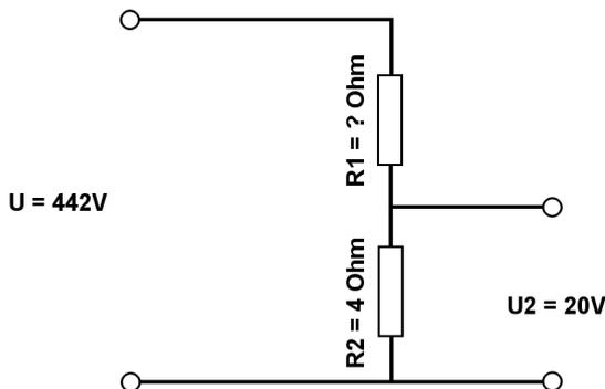
Berechne mit der Spannungsteilerregel die fehlenden Werte.
