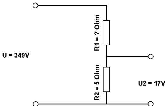
Berechne mit der Spannungsteilerregel die fehlenden Werte.
