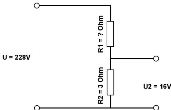
Berechne mit der Spannungsteilerregel die fehlenden Werte.
