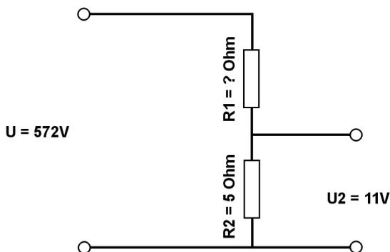
Berechne mit der Spannungsteilerregel die fehlenden Werte.
