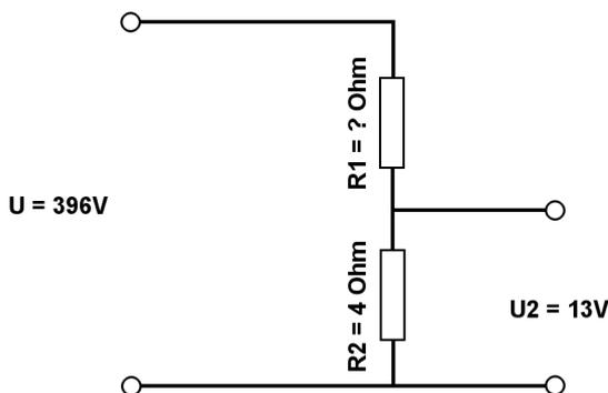
Berechne mit der Spannungsteilerregel die fehlenden Werte.
