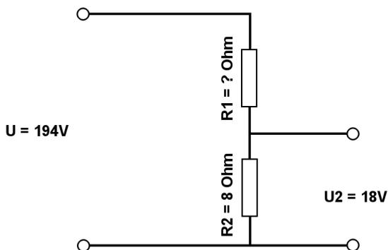
Berechne mit der Spannungsteilerregel die fehlenden Werte.
