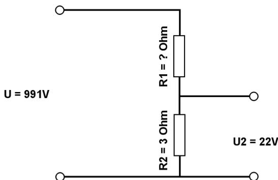
Berechne mit der Spannungsteilerregel die fehlenden Werte.
