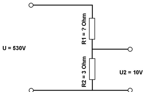
Berechne mit der Spannungsteilerregel die fehlenden Werte.
