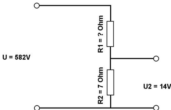
Berechne mit der Spannungsteilerregel die fehlenden Werte.
