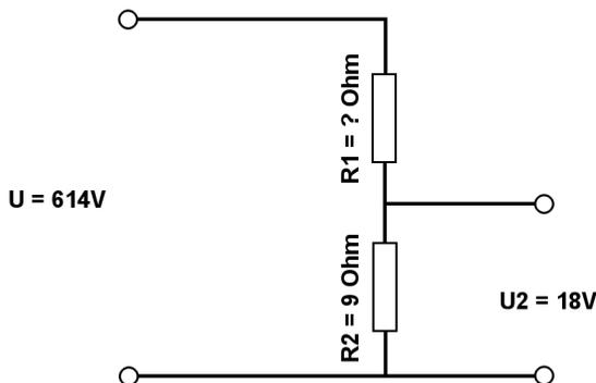
Berechne mit der Spannungsteilerregel die fehlenden Werte.
