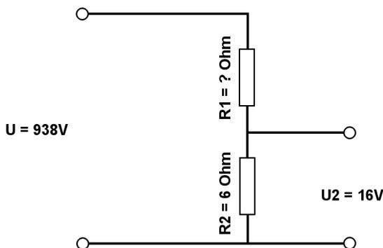
Berechne mit der Spannungsteilerregel die fehlenden Werte.
